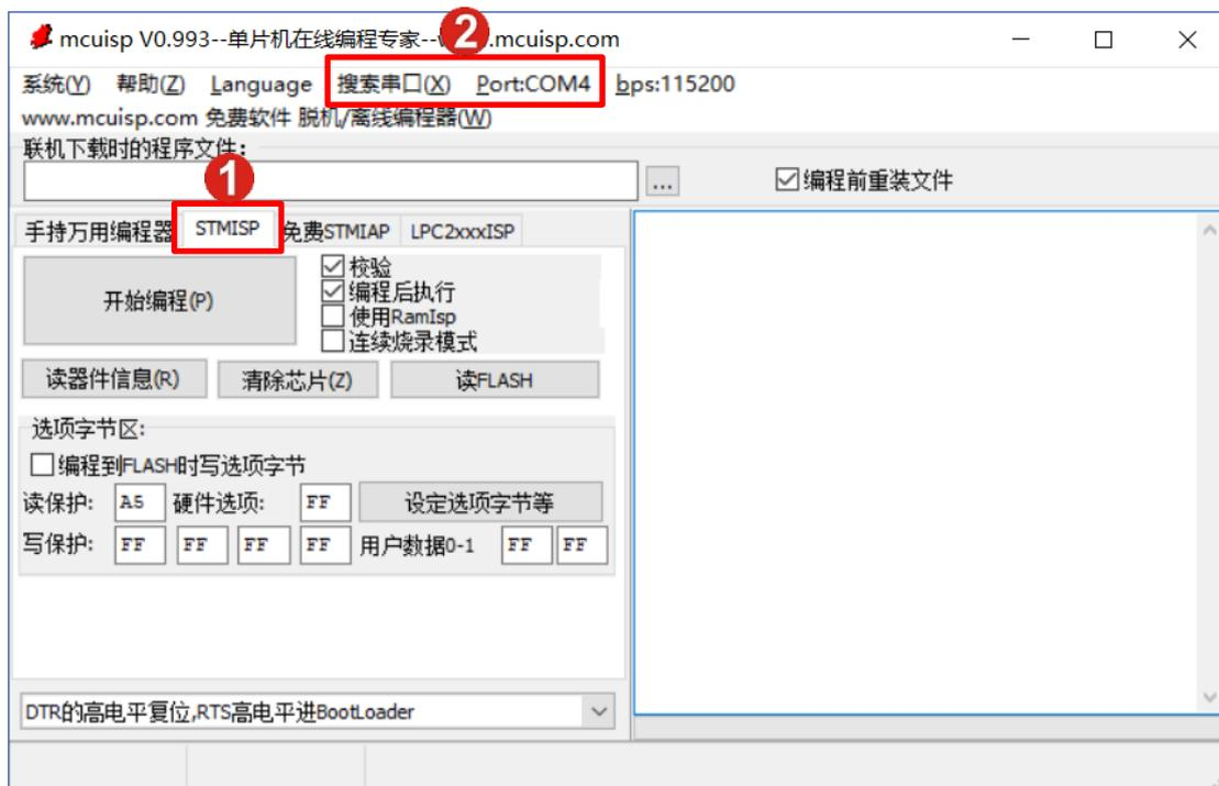
5. 选择之前从网站上下载的固件，并在下拉列表中选择“DTR 的低电平复位，RTS 高电平进 BootLoader”。
